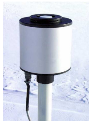
Longitudes de onda: 302 \pm 2.5 nm 312 \pm 2.5 nm 320 \pm 2.5 nm 340 \pm 2.5 nm 380 \pm 2.5 nm 400-700 nm PAR Anchura de banda de 10 nm
