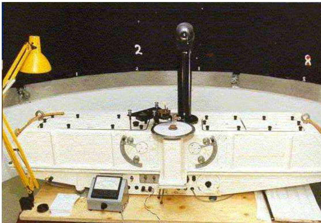
Figura 4.5. Fotografía del espectrofotómetro Dobson#120 en "El Arenosillo".
